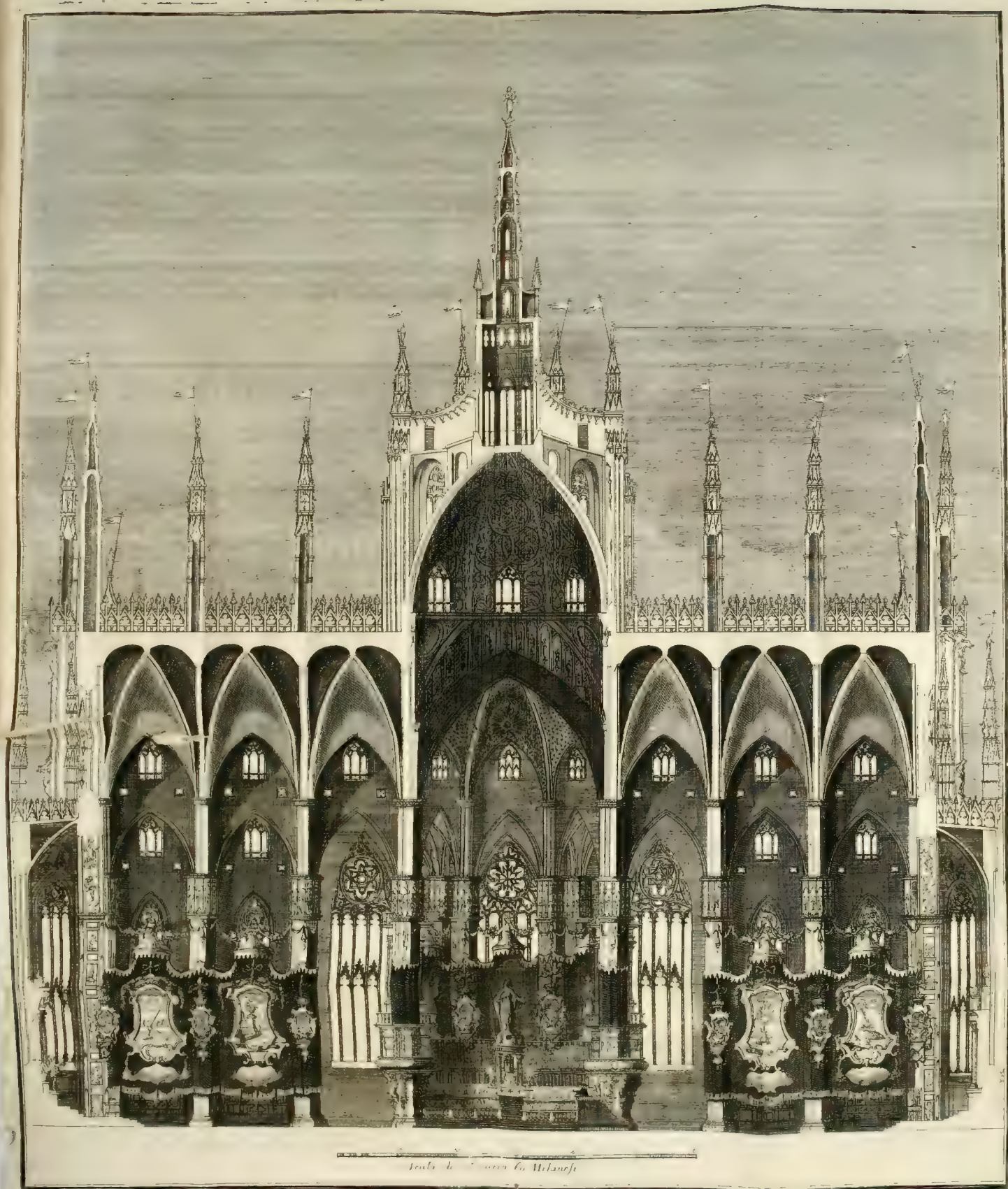
Spaccato della parte superiore della Croce del Duomo di Milano.
